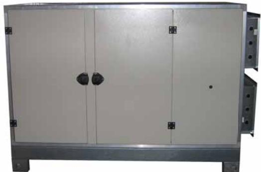
Kućište je od eloksiranog aluminijumskog profila spojen sa plastičnim rogljevima pojačan staklenim vlaknima. Paneli su od pocinkovanog ili plastificiranog čeličnog lima. Standardno termoizolovani  $\delta= 19-35\text{mm}$ .
